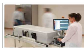
Abb.2: Bentley FTS-Milchanalysegerät (Quelle: Bentley-Instrumenta)
